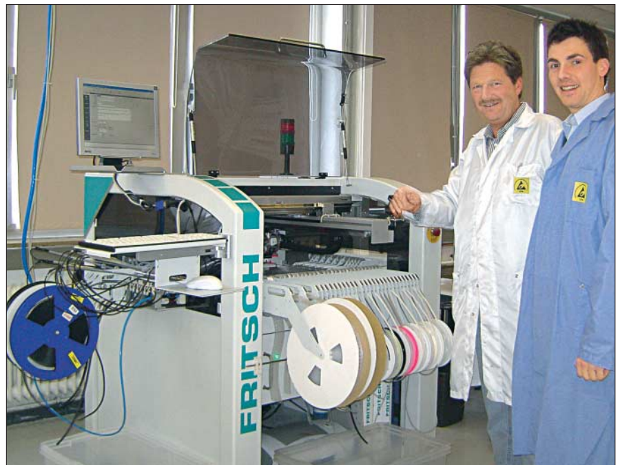
Bild 1: Freuen sich über eine enge Zusammenarbeit: Theo Schelasni (links), R&D Elektronik und Karl-Heinz Weißer, Fritsch vor dem Bestückautomaten Place All 600
