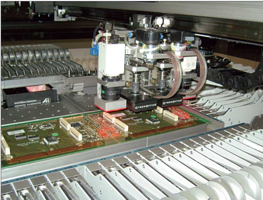
Bild 2: Das Herz des Bestückautomaten Place All 600: Mittels der Laserzentrierung am Bestückkopf und dem stationären Visionsystem lassen sich komplizierte und komplexe Bauteile sowohl sicher als auch präzise bestücken.
